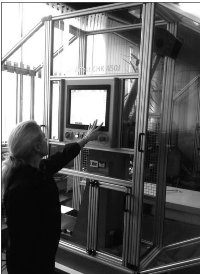
Mirosława Kokoszka z hutniczego laboratorium badań niszczących obsługuje nowy, zautomatyzowany młot do prób udarowości.
