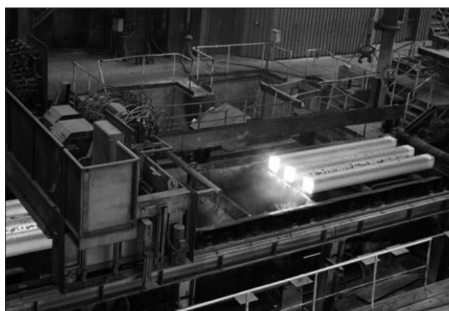
Odlewanie słabów o kwadratowym przekroju.
