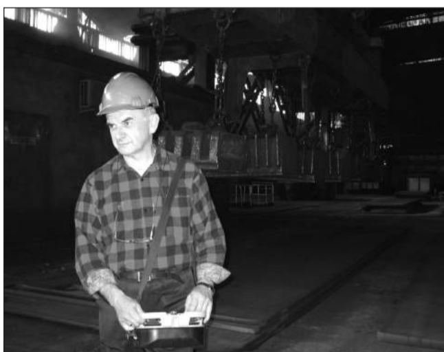
Suwnice w hali WBG przystosowano do sterowania za pomocą radia.
