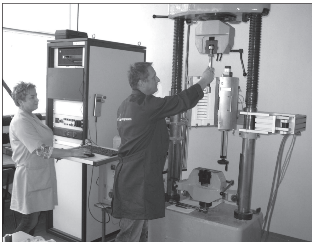
Nowoczesna maszyna do badań wytrzymałościowych prób w podwyższonej temperaturze zainstalowana w wyremontowanym laboratorium na terenie WBG. Z prawej strony otwarty piec do podgrzewania prób.
